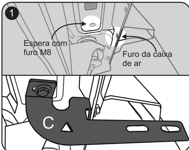
Obs.: - mesma forma de fixação para todos os suportes (D,E,F), em alguns furos da 'aba' da caixa de ar o parafuso 'G' entra mais forçado.
