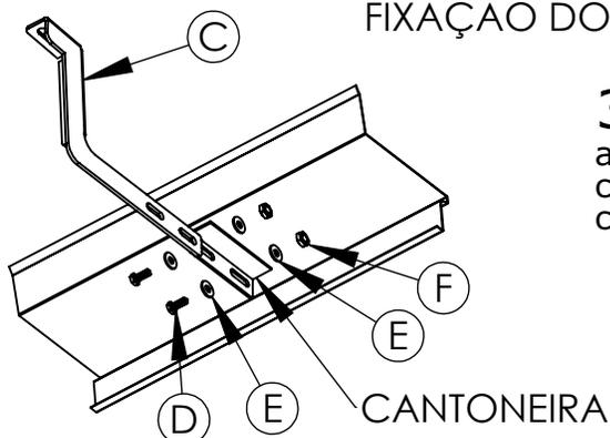
3- Fixar os estribos "A" e "B" nos suportes "C" com auxílio dos parafusos "D", arruelas "E" e porcas "F", cuidando para que os suportes fiquem por dentro das cantoneiras dos estribos conforme figura ao lado.
