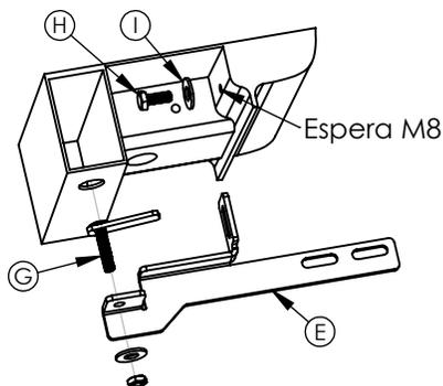
2 - Encaixar os pontaletes "G" na caixa de ar do veículo conforme figura ao lado e fixar suportes "E" e "F" com auxílio dos parafusos "H", arruelas "I" e nos Pontaletes "G" com as porcas e arruelas que seguem nos pontaletes.
