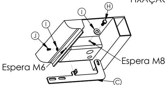
1 - Fixar suportes "C" e "D" na parte inferior frontal do veículo com auxílio dos parafusos "H" e "J", e arruelas "I" (em ambos os lados do veículo).
