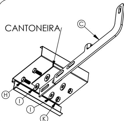
3 - Fixar os estribos "A" e "B" nos suportes "C", "D", "E" e "F" com auxílio dos parafusos "H", arruelas "I" e porcas "K", cuidando para que os suportes fiquem por dentro das cantoneiras dos estribos conforme figura ao lado.
