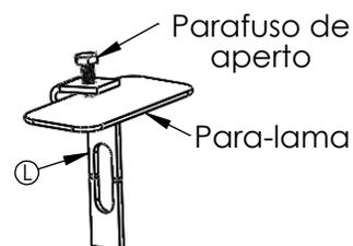
Obs: Usar o parafuso que segue no suporte para aperto, pressionando o para-lama e realizando a fixação
