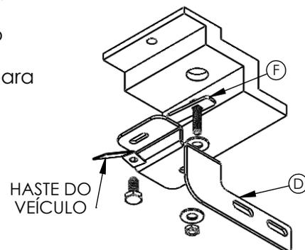
5 - Posicionar suporte "D" como mostra a figura, entre a caixa de ar e a haste OBS: Para o furo superior, fixando com o parafuso original, ainda sem o aperto final.
