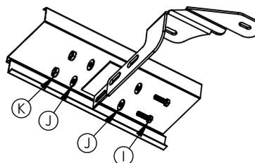
7 - Fixar os estribos "A" e "B" nos suportes "C", "D", "E", com auxílio dos parafusos "I", arruelas "J" e porcas "K"
