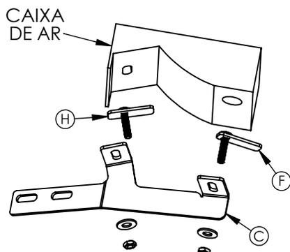
2-Posicionar os suportes "C", centralizando com os furos e fixando com auxílio das arruelas e porcas que seguem junto com o pontaletes, sem efetuar o aperto final.
