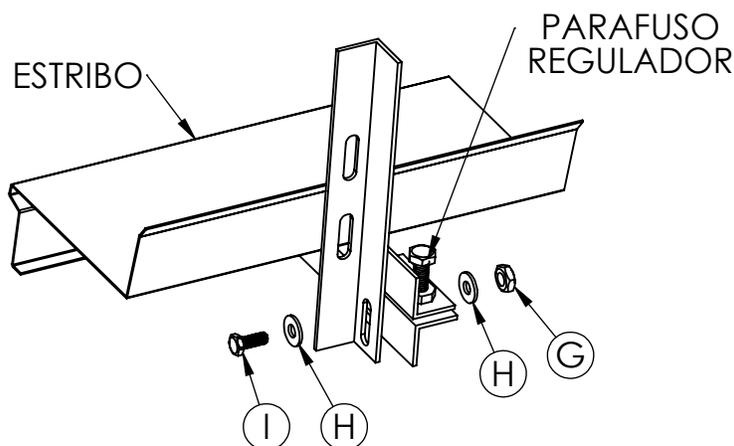
7 - Verificar a necessidade de nivelar os estribos, utilizando os PARAFUSOS DE REGULAGEM que seguem nos suportes.
