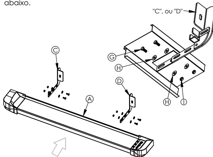
**7** - Verificar se as ponteiros encaixam perfeitamente na lateral do veículo e efetuar o aperto final em todos os parafusos.
