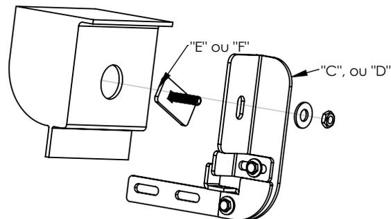
**5** - Regular as travas dos suportes de forma que fiquem pressionando a "ABA" da caixa de ar do veículo, dando uma maior resistência ao suporte conforme figura abaixo.
