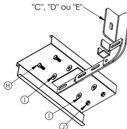
7 - Verificar se o estribo está alinhado corretamente com a lateral do veículo e efetuar o aperto final dos parafusos.
