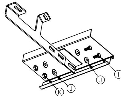
**5-** Verificar se as ponteiros encaixam perfeitamente na lateral do veículo e efetuar o aperto final em todo conjunto.
