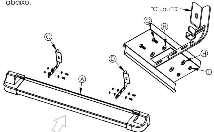
7 - Verificar se as ponteiros encaixam perfeitamente na lateral do veículo e efetuar o aperto final em todos os parafusos.
