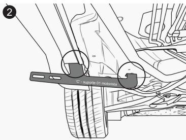
2- Retirar o tampão de borracha do furo onde será inserido o pontalete dianteiro e posicionar o pontalete "G". Em seguida fixar o suporte "e" no pontalete e no furo da carroceria com auxílio de um parafuso "I", arruelas "K" e porca "J" sem efetuar o aperto final.
