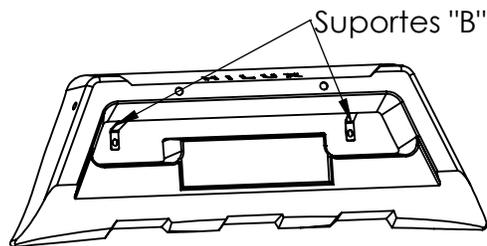
6- Encaixar os suportes "B" por entre as grades de entrada de ar do veículo, em seguida fixar os suportes no bumper (deixando-os escondidos por trás do bumper), com auxílio dos parafusos "D", arruelas "F" e porcas "G", sem efetuar o aperto final ainda.
