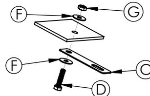
9- Retirar os Parafusos Auto atarrachante originais do veículo, que se encontram na parte inferior do para-choque e fixar os suportes "C" já montados no bumper nos mesmos orifícios substituindo os parafusos originais pelos parafusos "H".
