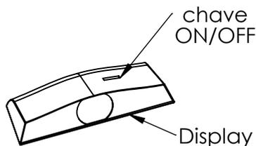
**OBS:** Na parte superior do Display, existe uma chave com a opção de ligar e desligar o som emitido pelo sensor, permanece apenas o leitor de distância.
