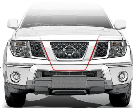
A **linha inferior do parachoque é evidenciada** também no desenho do acessório e na sua pintura diferenciada para melhor absorção frontal contra fragmentos.
