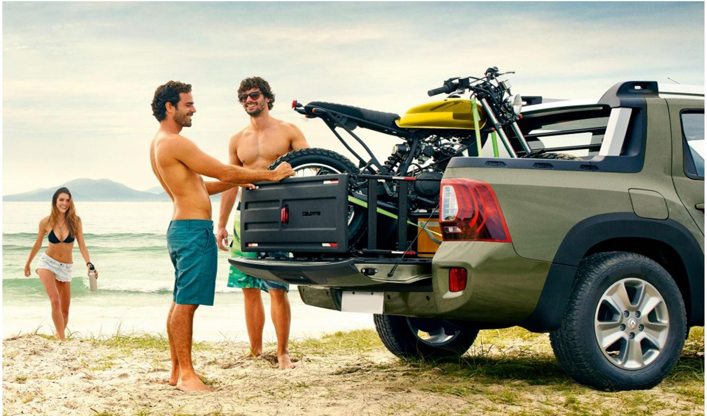
Versátil, o Extensor de Caçamba tem como função principal aumentar a **capacidade de carga** - você ganha uma diagonal de 2m sem roubar espaço do banco traseiro. Também pode ser utilizado como **rampa de acesso** ou **divisor da carga** transportada.
