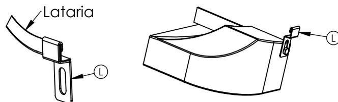
8 - Fixar os suportes "M" nos parafusos originais do para-lama dianteiro do veículo, e em seguida, fixar as ponteiras dianteiras nos suportes "M" com os parafusos e porcas que seguem nos suportes.
