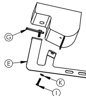
5 - Fixar o suporte "E" no pontaletes "G" e no orifício onde foi retirado o parafuso original, substituindo pelo parafuso "I" e arruela "K".
