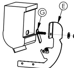
4- Para instalar os suportes "E" e "F", retirar o adesivo de vedação do orifício da caixa de ar e inserir os pontaletes "G" (sem a porca) com muito cuidado para não deixá-los cair. Em seguida encaixar os suportes e fixá-los com as porcas e arruelas que seguem nos pontaletes, conforme figura ao lado.
