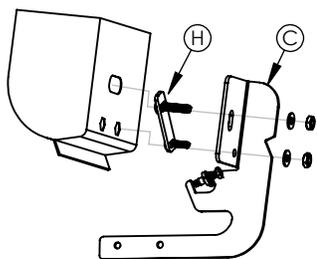
2- Encaixar os suportes "C" e "D" e fixar com as porcas e arruelas que seguem nos pontaletes, conforme figura ao lado.
