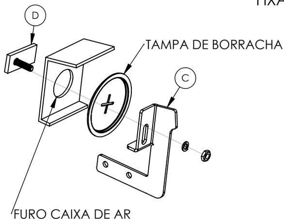
1 - Retirar a tampa da borracha da caixa de ar do veículo, nas posições onde serão instalados os suportes "C".
