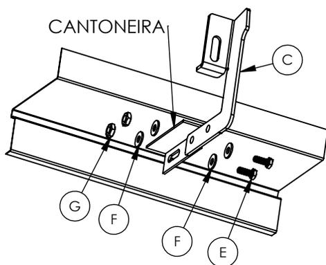
5 - Fixar os estribos "A" e "B" nos suportes "C" com auxílio dos parafusos "E", arruelas "F" e porcas "G", cuidando para que o estribo fique por dentro das cantoneiras conforme imagem ao lado.
