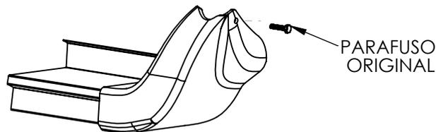
6- Verificar se os estribos estão alinhados com a lateral do veículo de forma que preencha todos os espaços e mantenha o nivelamento, e efetuar o aperto final de todos os parafusos.
