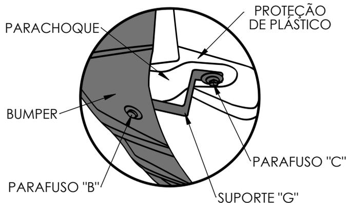
Passo 05- Fixar o Bumper na outra ponta do suporte "G" com os parafusos "B", Porcas "D" e arruelas "E", finalizando assim a instalação.
