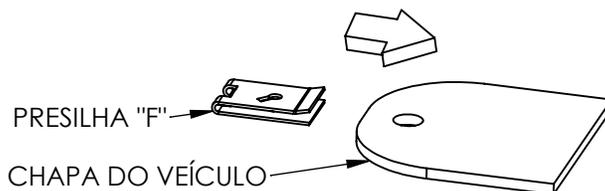
Passo 04- Fixar os suportes "G" junto com a proteção de plástico e o parachoque nas presilhas "F" encaixadas na chapa do veículo com auxílio dos parafusos "C".
