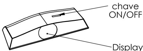
OBS: Na parte superior do Display, existe uma chave com a opção de ligar e desligar o som emitido pelo sensor, permanece apenas o leitor de distância.
