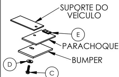
8 - Encaixar as presilhas "E" no suporte do veículo e fixar o bumper com o parachoque no suporte com os parafusos "C" e arruelas "D" conforme figura ao lado.
