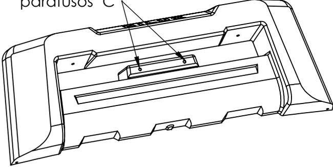
**3** - Em seguida, fixar o Bumper nas duas esperas com rosca M6 onde era fixada a placa, com auxílio dos parafusos "C" e arruelas "E".
