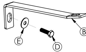
**5** - Retirar os quatro Parafusos originais do veículo, que se encontram na parte inferior do parachoque e fixar bumper nos mesmos orifícios substituindo os parafusos originais pelos parafusos "G".
