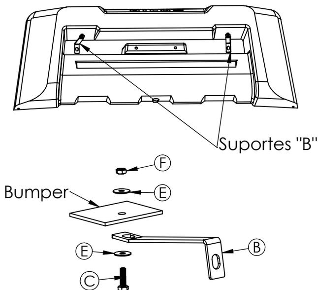
**2** - Retirar a placa do veículo e encaixar o bumper, direcionando os suportes "B" já montados por entre as grades de entrada de ar.
