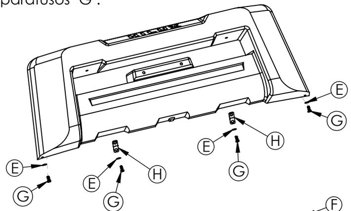
**6** - Nos furos do meio, na parte inferior do bumper, utilizar os suportes "H" para fixação conforme imagem ao lado.
