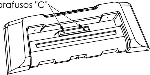
**3** - Em seguida, fixar o Bumper nas duas esperas com rosca M6 onde era fixado a placa, com auxílio dos parafusos "C" e arruelas "E".
