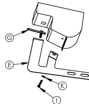
5 - Fixar o suporte "E" no pontaletes "G" e no orifício onde foi retirado o parafuso original, substituindo pelo parafuso "I" e arruela "K".
