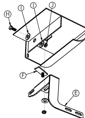
3 - Retirar a borracha de proteção e inserir Fixador "F" na caixa de ar do veículo, em seguida montar os suportes "E" com auxílio dos parafusos que seguem no fixador e dos parafusos "H", porcas "J" e arruelas "I", conforme figura ao lado.
