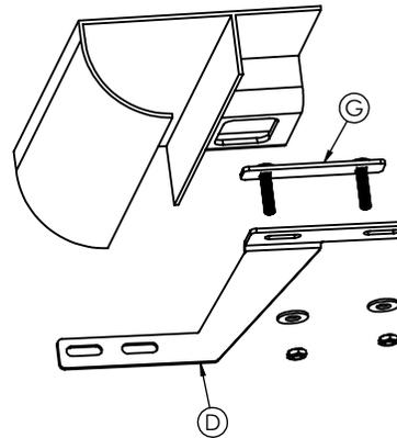
2 - Inserir fixador "G" na parte central da caixa de ar do veículo, e montar os suportes "D" com auxílio dos parafusos que seguem no fixador (em ambos os lados do veículo).
