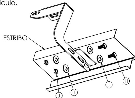
5 - Verificar se as ponteiros encaixam perfeitamente na lateral do veículo e efetuar o aperto final em todo conjunto.
