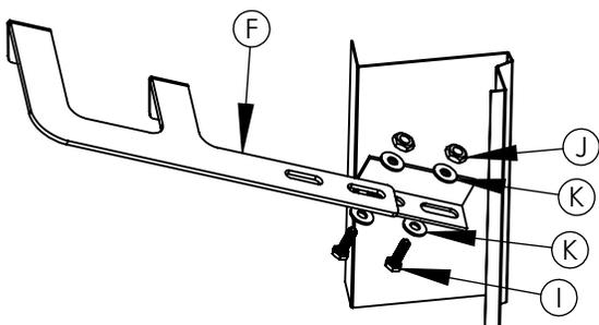
6- Fixar os estribos "A" e "B" nos suportes "C", "D", "E" e "F" com auxílio dos parafusos "I", arruelas "K" e porcas "J" cuidando para que os suportes fiquem por dentro das cantoneiras dos estribos, conforme figura ao lado.
