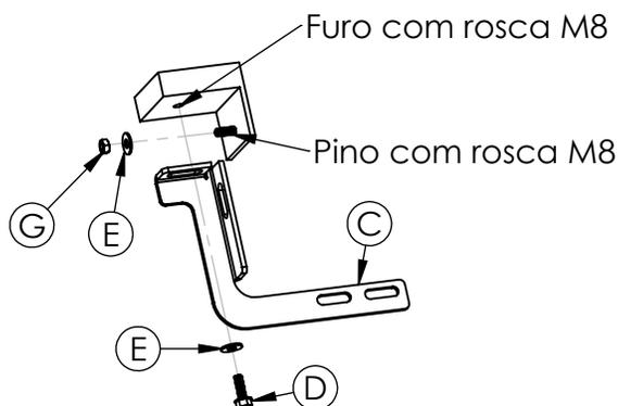
1 - Posicionar os suportes "C" nas esperas roscadas na caixa de ar do veículo com auxílio dos parafusos "D", arruelas "E" e porcas "G", sem efetuar aperto final (em ambos os lados do veículo).
