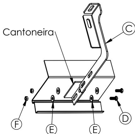
2 - Fixar os estribos "A" e "B" nos suportes "C" com auxílio dos parafusos "D", arruelas "E" e porcas "F", cuidando para que os suportes fiquem por dentro das cantoneiras dos estribos conforme figura ao lado.
