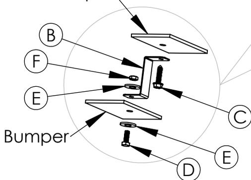
3- Fixar os suportes "B" no bumper com auxílio dos parafusos "D" arruelas "E" e porcas "F" conforme imagem acima, em seguida retirar os parafusos originais do paracheque do veículo e fixar os suportes nos mesmos furos substituindo os originais pelos parafusos "C".
